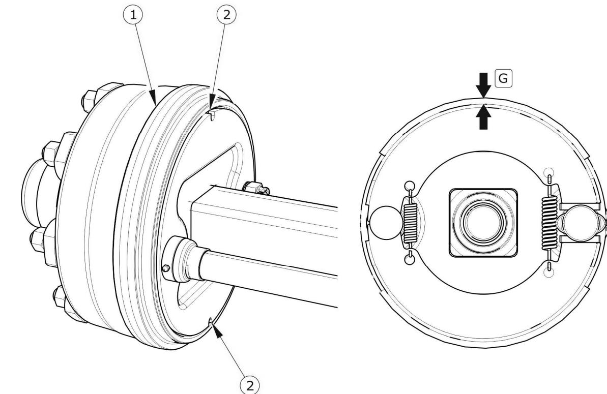
РИСУНОК 5.1 Проверка тормозных накладок
