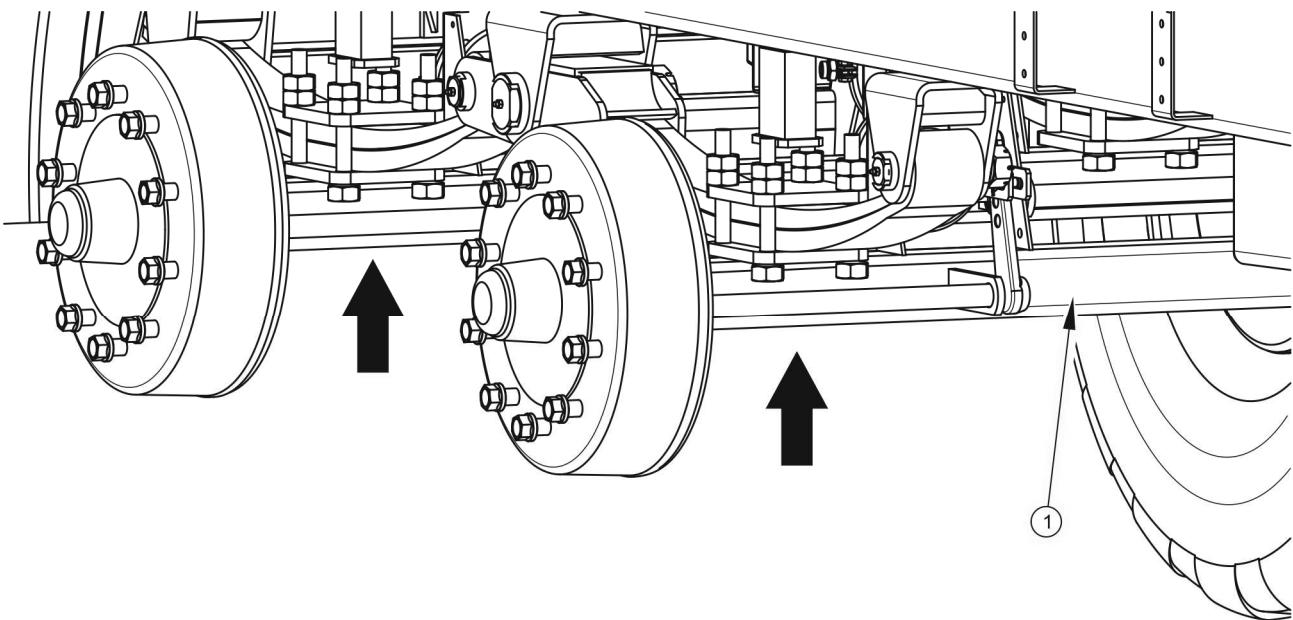
РИСУНОК 5.2 Точка поддомкрачивания
