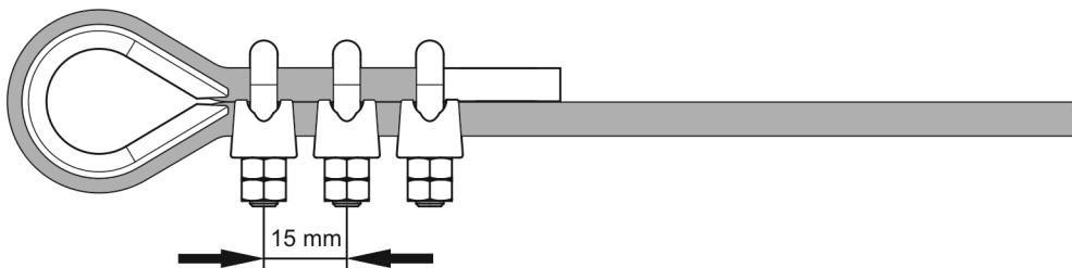
**РИСУНОК 5.7 Монтаж зажимов стального троса**
