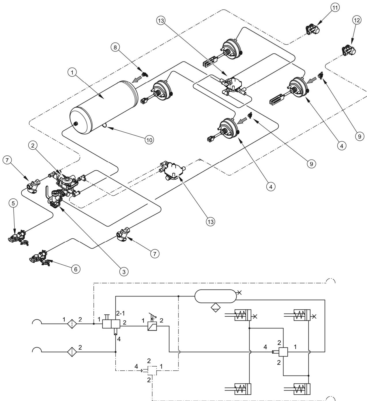
**РИСУНОК 3.4 Устройство и схема пневматической двухпроводной тормозной системы**
