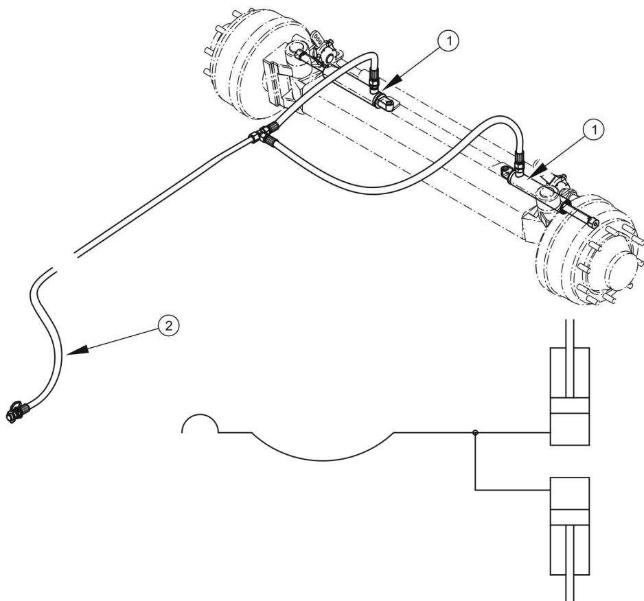
**РИСУНОК 3.11 Устройство и схема гидравлического блокирования поворота**
