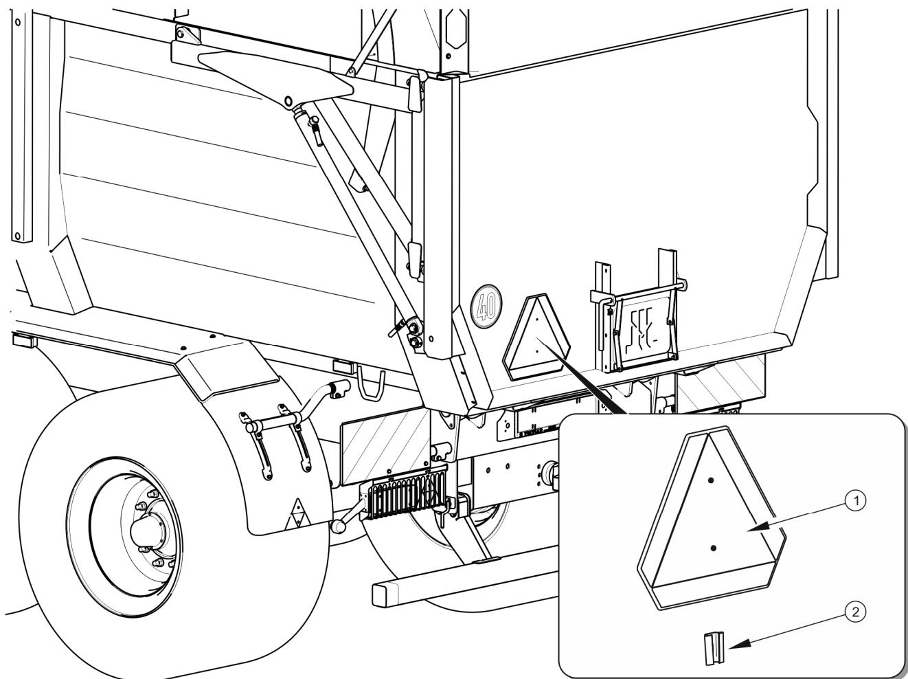
**РИСУНОК 2.2 Размещение трехугольного знака медленно движущегося транспортного средства.**
