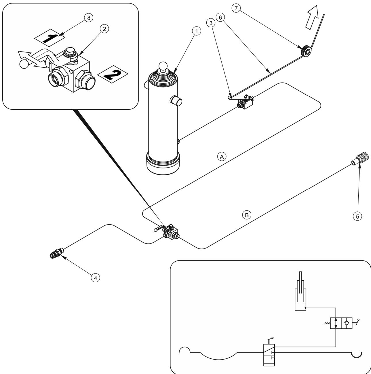
**РИСУНОК 3.8 Устройство и схема гидравлической системы опрокидывания "тандем"**
