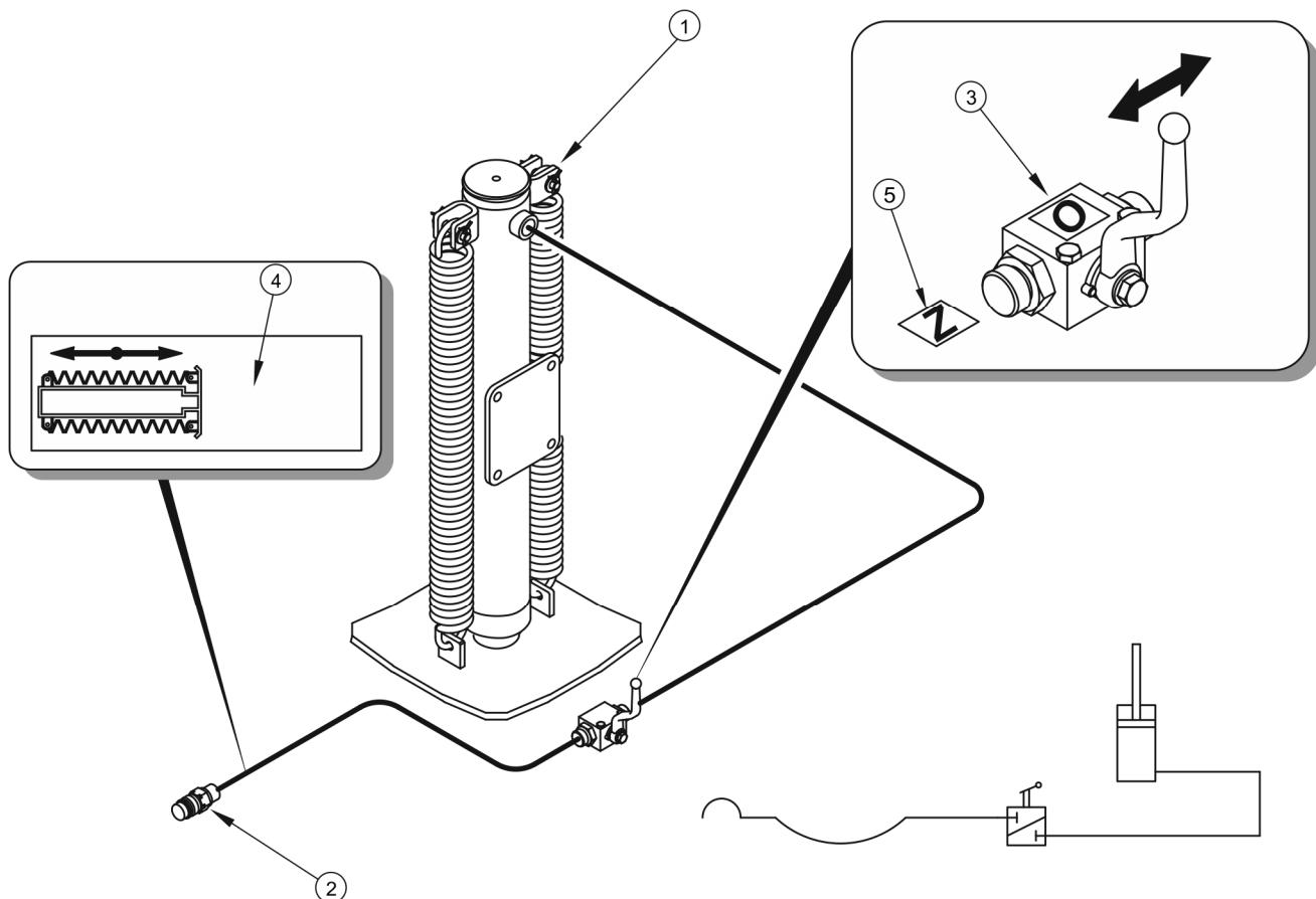
**РИСУНОК 3.10 Устройство и схема гидравлической системы прямой опоры**
