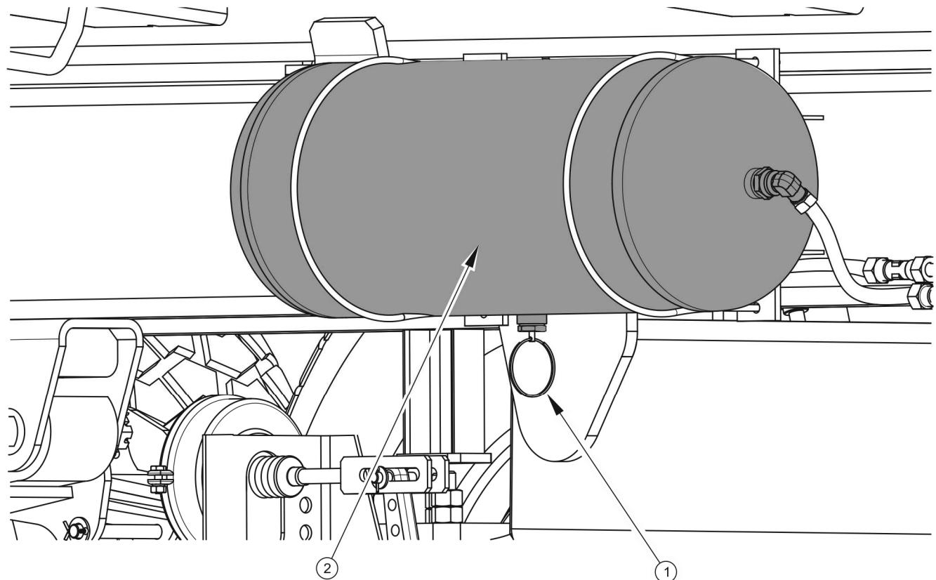
**РИСУНОК 5.9 Отвод конденсата из емкости для сжатого воздуха**
