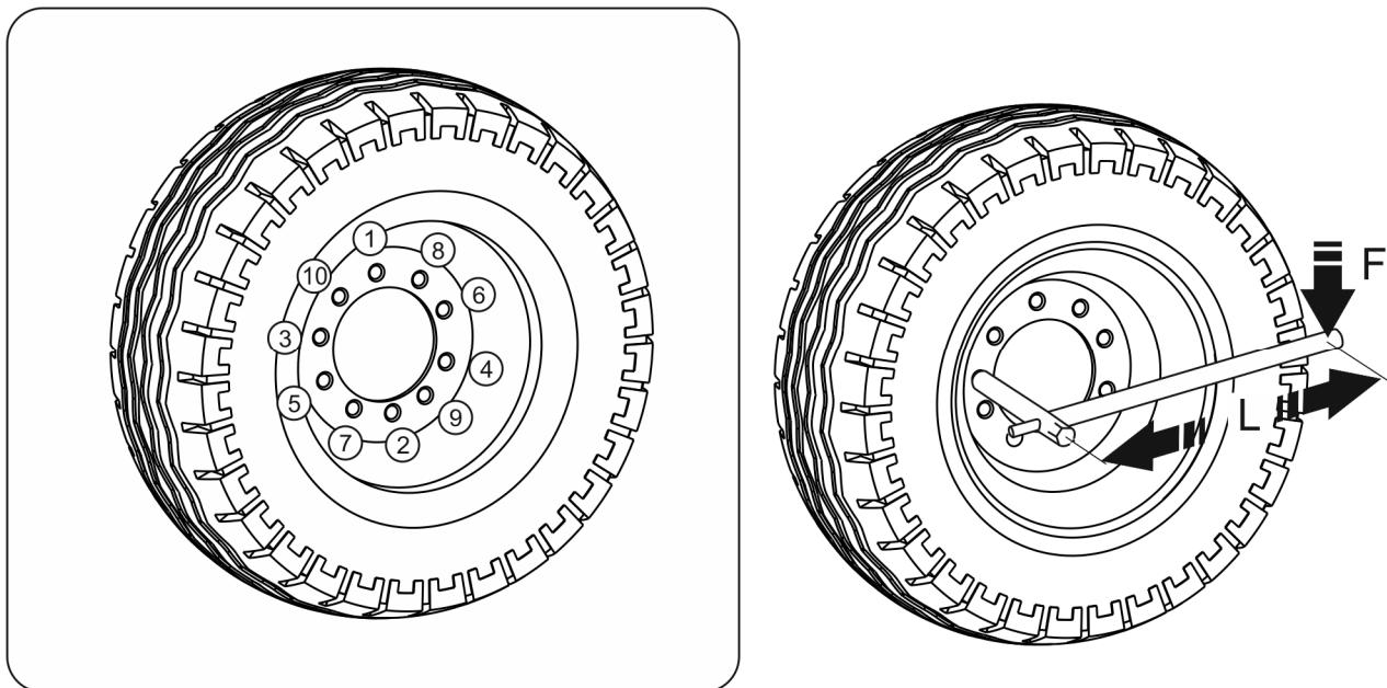
**РИСУНОК 5.4** Очередность затяжки гаек, оси с 10 шпильками М22x1.5
