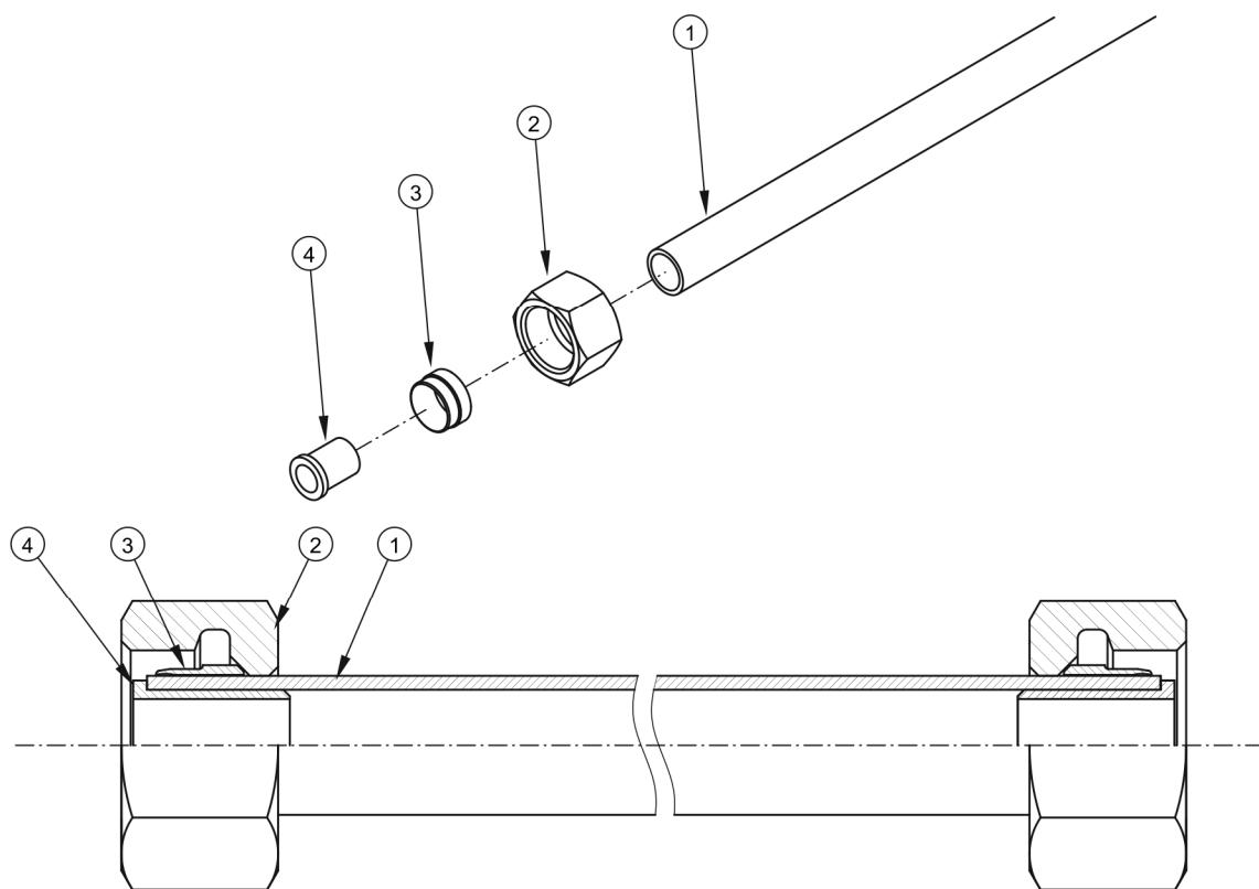
**РИСУНОК 5.10 Монтаж пневмопровода**
