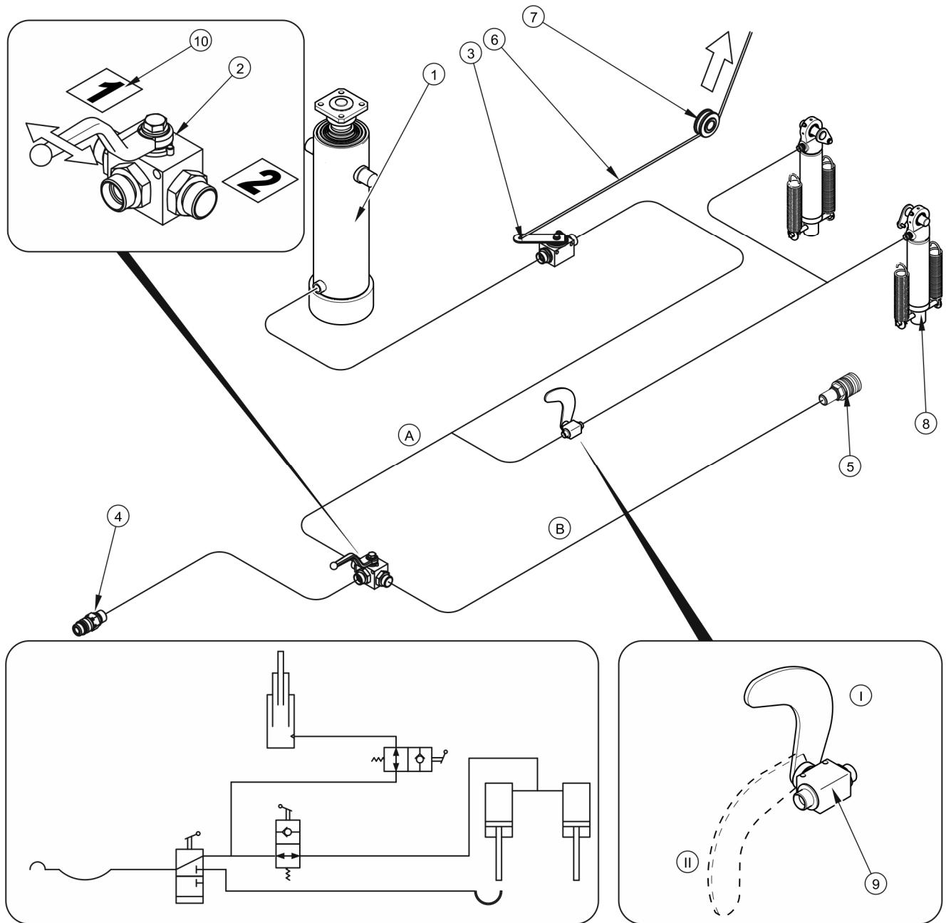
**РИСУНОК 3.9 Устройство и схема гидравлической системы опрокидывания bogie**
