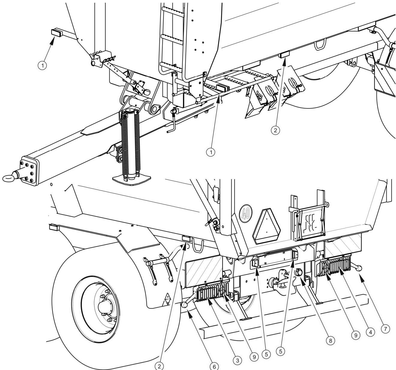
**РИСУНОК 3.14 Размещение элементов электрической системы и светоотражающей сигнализации**
