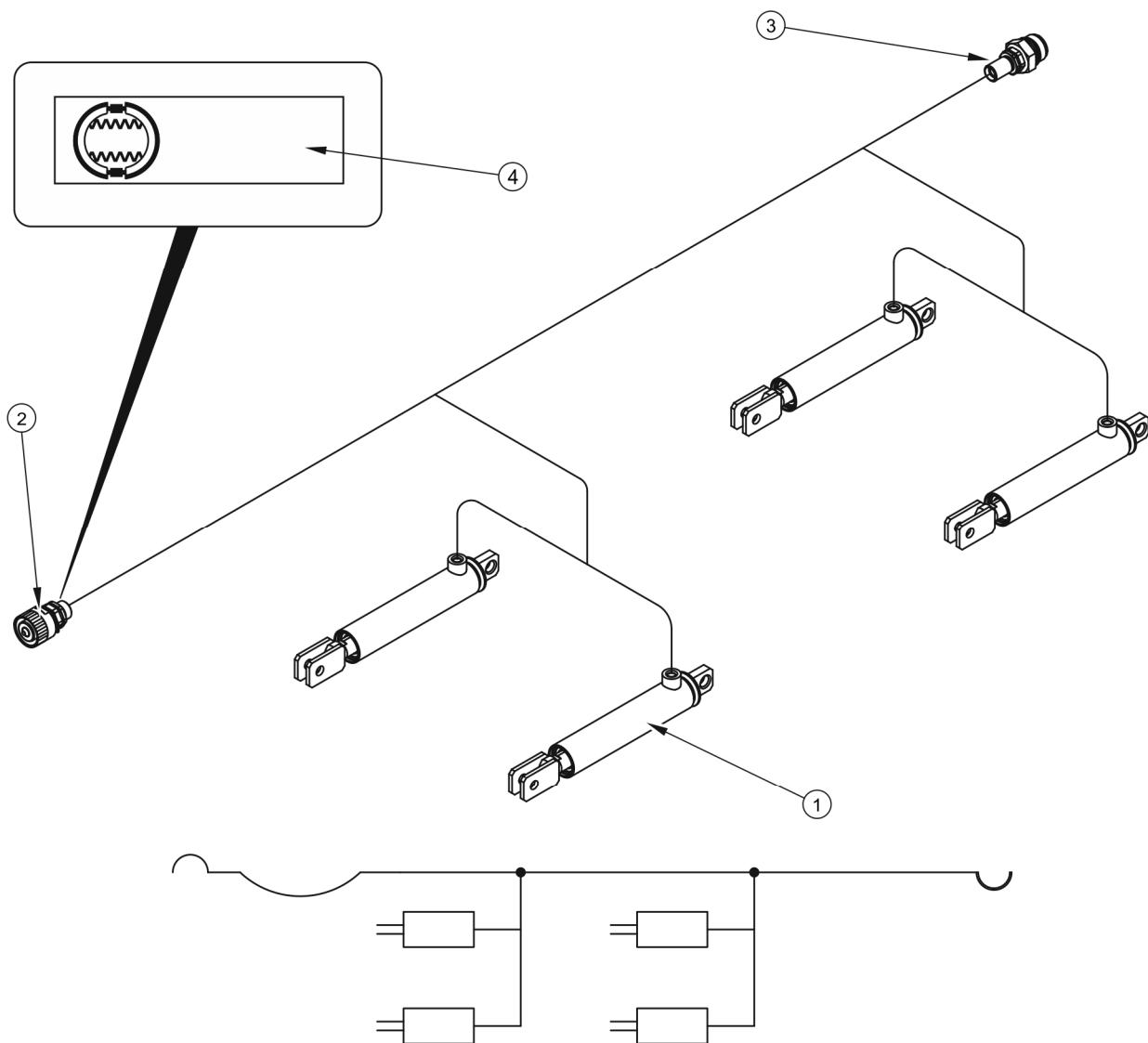
**РИСУНОК 3.6 Устройство и схема гидравлической тормозной системы**
