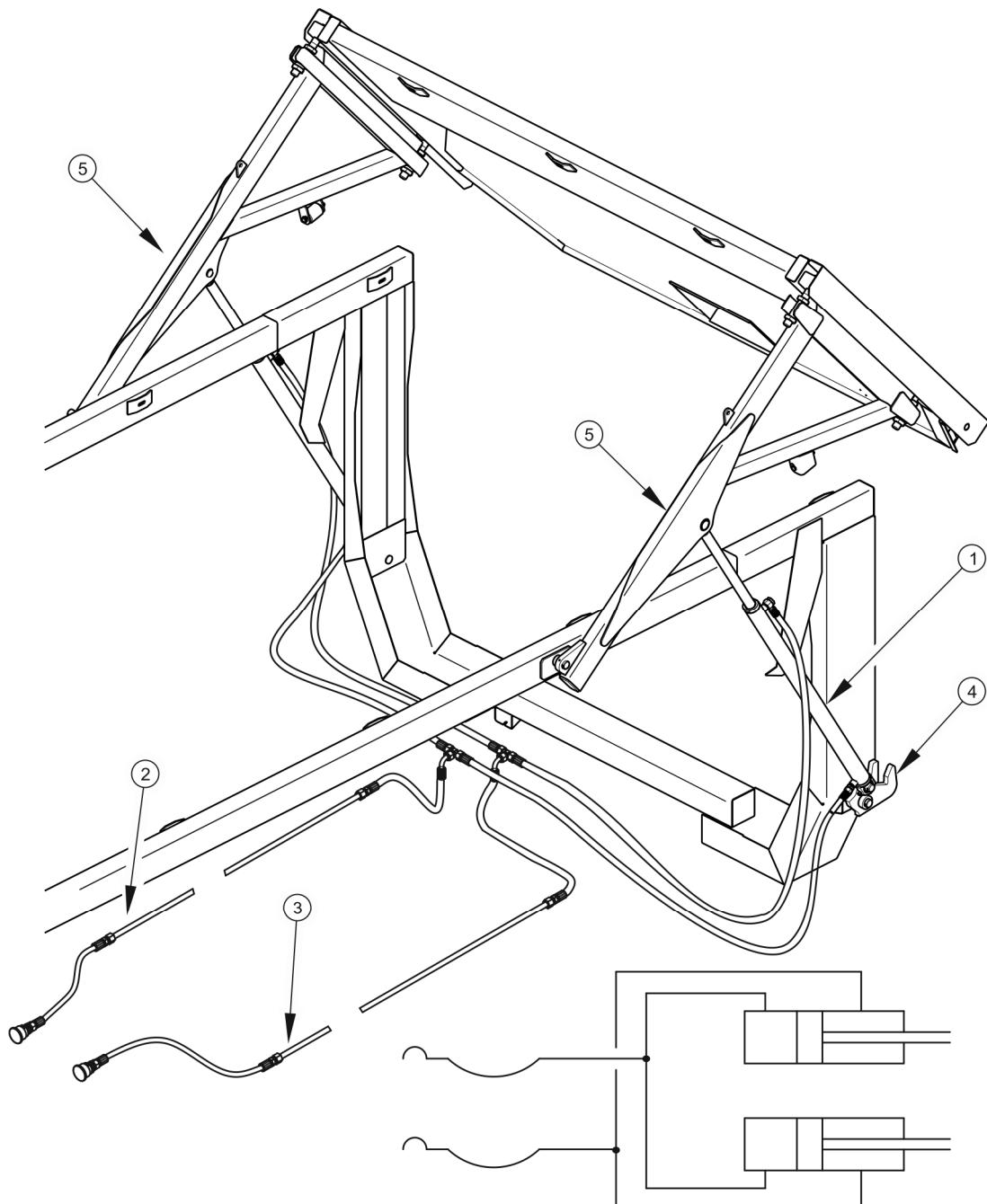
**РИСУНОК 3.12 Устройство и схема гидравлической системы заднего борта**
