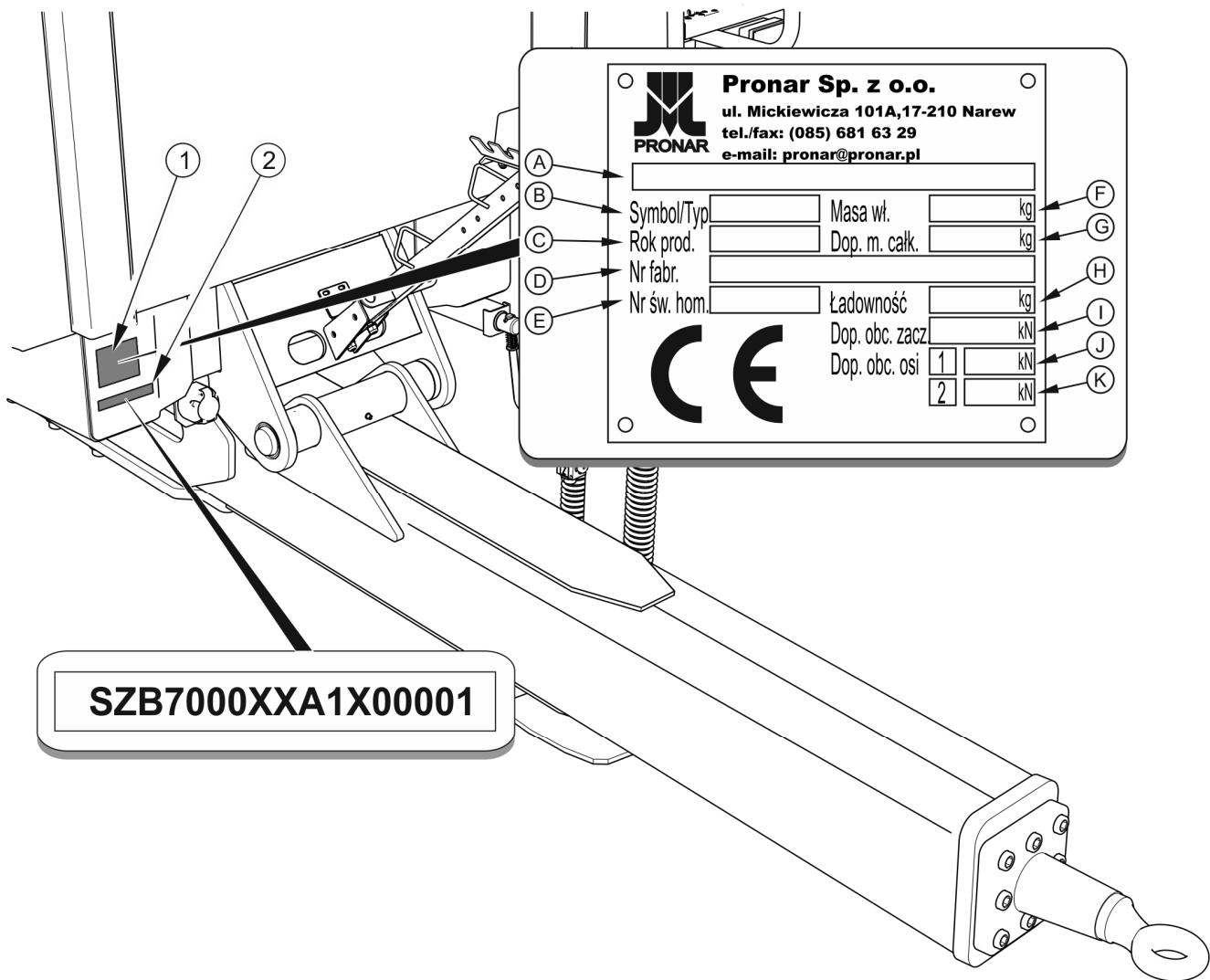
**РИСУНОК 1.1 Размещение заводского щитка и серийного номера**
