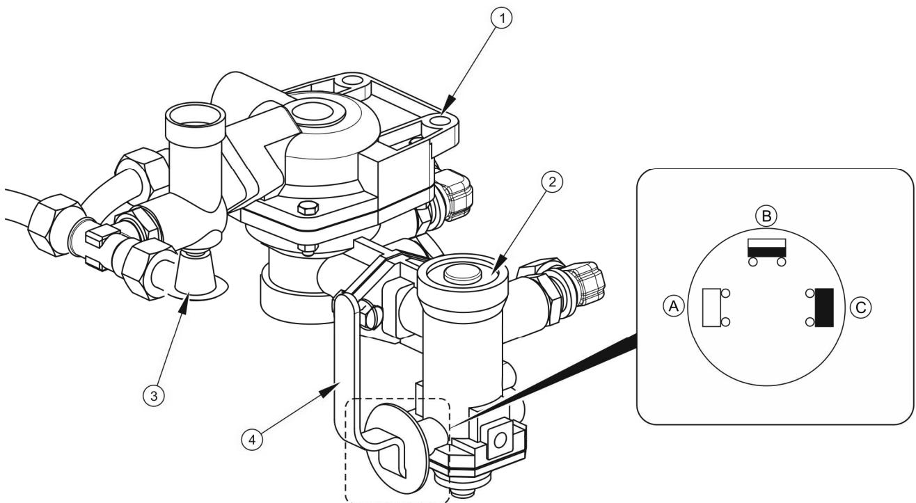
**РИСУНОК 3.7 Управляющий клапан и регулятор силы торможения**
