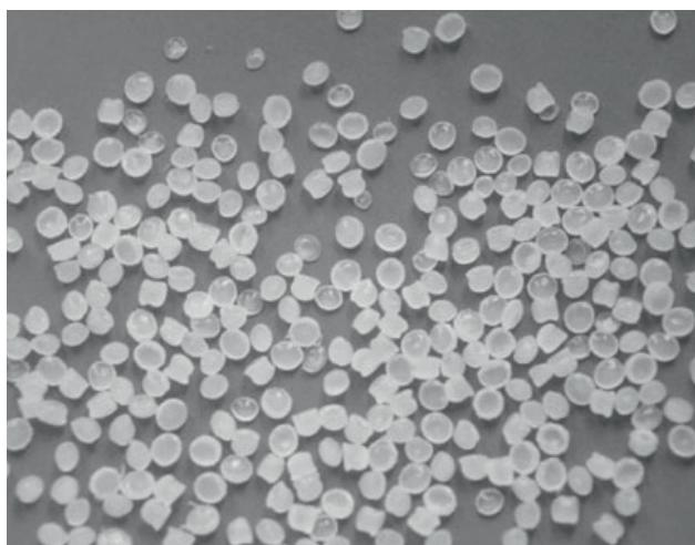
Полиэтилен- Гранулированная форма
