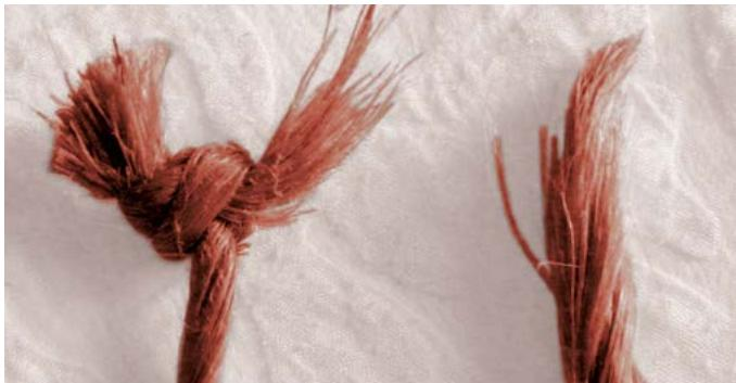
На узлах нагрузка шпагата достигает максимума. При низкой прочности узлов существует риск разрыва шпагата.
