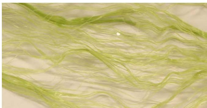
В разрезе шпагата узнаются обработанные полиэтиленовые волокна
