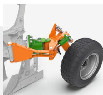
Механическое маятниковое опорное колесо, сзади
