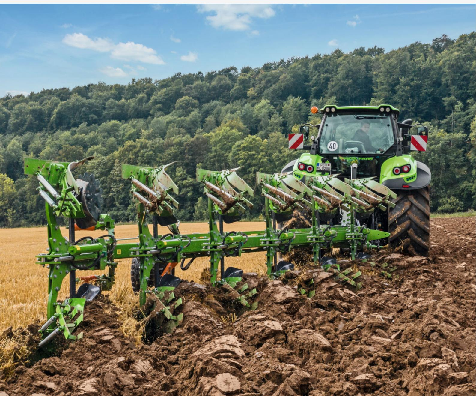
Точная адаптация ширины первой борозды при изменении ширины захвата с помощью параллелограмма
