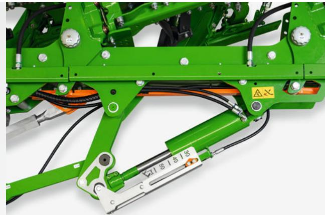
Гидравлическая регулировка ширины захвата
